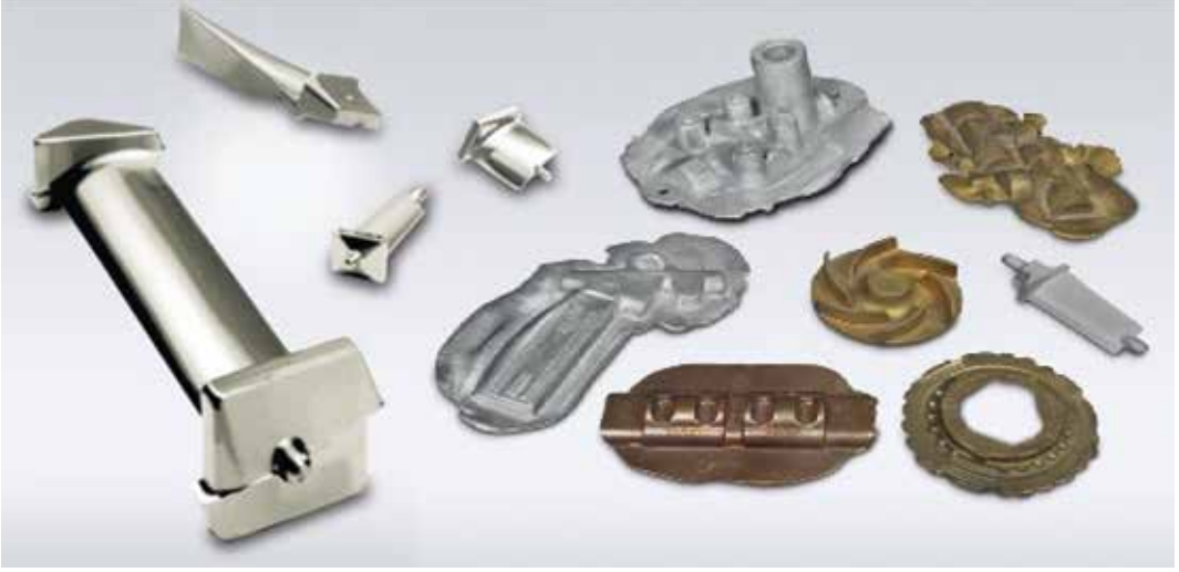
Resim 7.2. Vidalı Preslerde Üretilen Karakteristik Sıcak Dövme Parça Örnekleri
