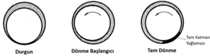
Şekil 7.24. Kaymalı Yatakta Tam Katman Yağlama Oluşması
