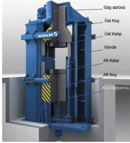
Şekil 7.5. Karşı Vuruşlu Dövme Çekicinin Şematik Gösterimi
