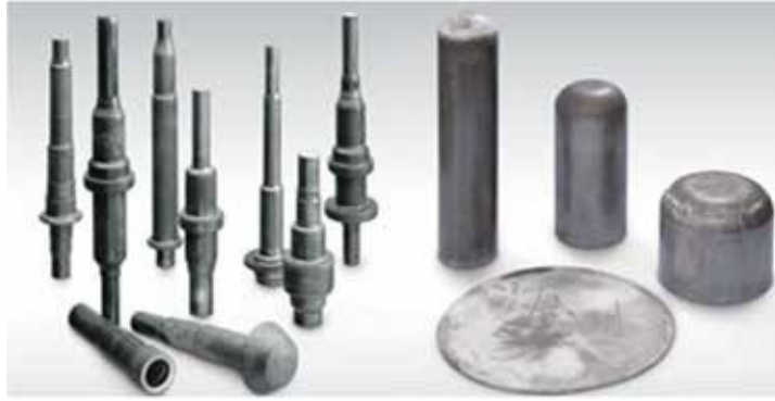
Resim 7.3. Hidrolik Preslerde Dövülen Şanzıman Milleri ve CNG Tüpleri
