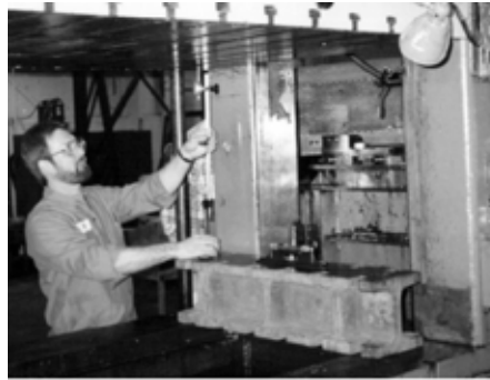
Şekil 7.20. Bir Bakım Teknisyeninin Pres Üst Tablasının Alt Tablaya Paralelliğini Kontrol Etmesi
