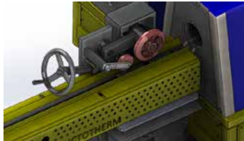
Resim 6.5. Pinch Roll Mekanizması
