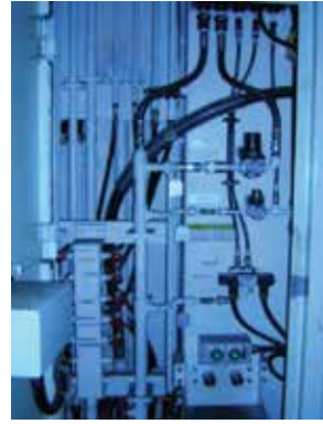
Sağ Arka Upright Yağlama Sistemi
