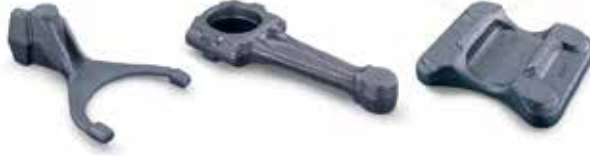
Şekil 7.1. Çekişte Üretilen Karakteristik Sıcak Dövme Parça Örnekleri
