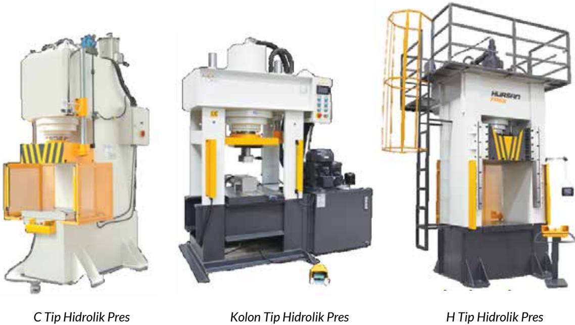
Resim 1.1. Hidrolik Preslerin Gövde Yapıları
